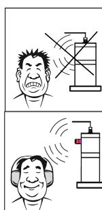
**Nivel de ruidos:** Los niveles de ruido de un impactador instalado sobre una placa de metal y sin pantallas protectoras podrán exceder de 85 dB (A). El sonido emitido por el equipo se puede reducir usando sistemas de revestimiento
